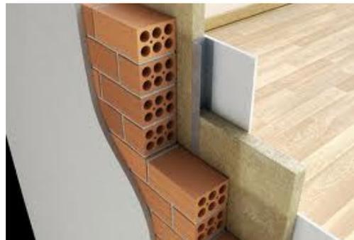
Paredes com isolamento térmico
